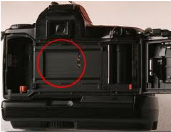
Fig.-31.- Respaldo cámara reflex: el obturador.
